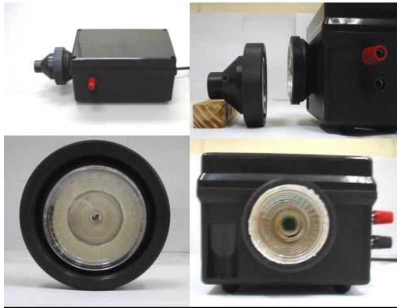
Figura 2.3 – Fotos do módulo de detecção construído, empregando um fotodiodo de silício e a cela de medida de tubo de polietileno em espiral, para o monitoramento da radiação quimiluminescente.
