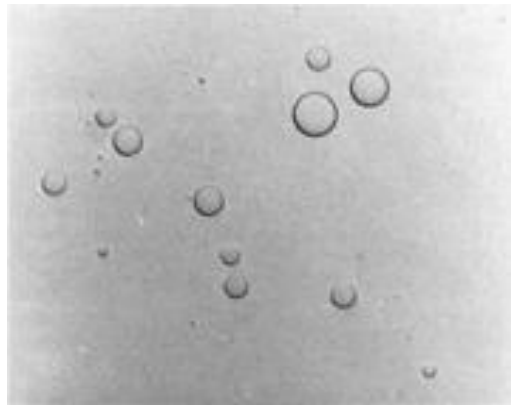
Figura 5 – Fenômeno de coalescência observado por microscopia óptica. O sistema torna-se heterogêneo, mas sem agregados (ANSEL et al., 1999).
