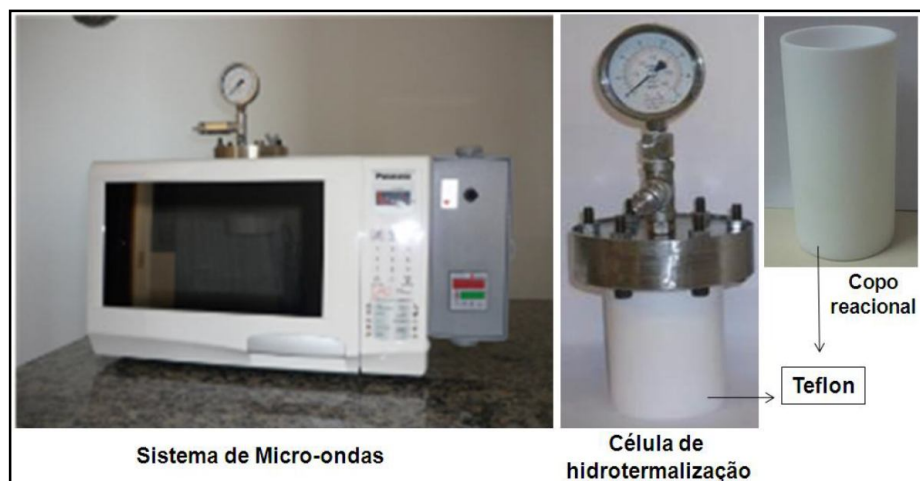
FIGURA 3.1 - Adaptação de um micro-ondas doméstico para síntese pelo método solvotérmico assistido por micro-ondas.
