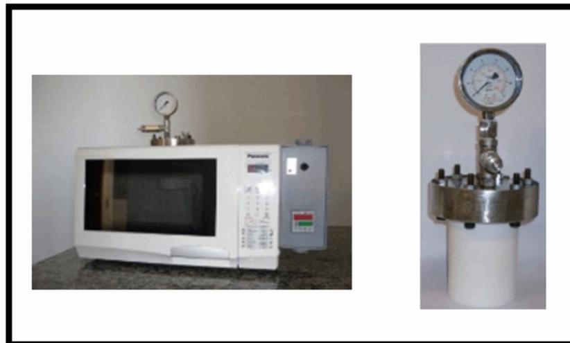
FIGURA 3. 1 - Foto do equipamento Hidrotérmico assistido por micro-ondas utilizado nas sínteses.
