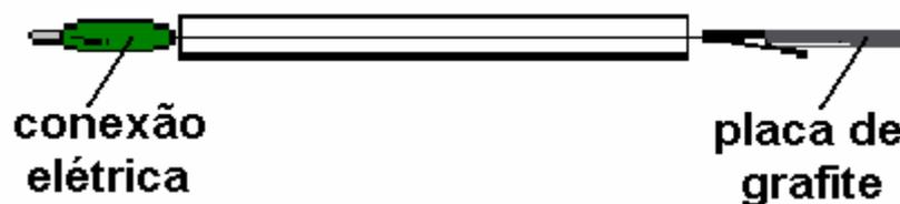
FIGURA 2.3 – Representação esquemática do contra-eletródo.
