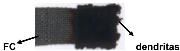
FIGURA 3.8 - Fotografia do compósito  $\text{Ppy}(\text{Li}_{1,05}\text{Mn}_2\text{O}_4 [0,25 \text{ g.L}^{-1}])_{\text{agitação}}/\text{FC}$ .
