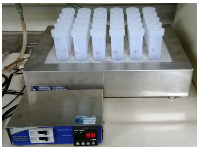
FIGURA 4.3.1 Esquema do bloco digestor e frascos fechados utilizados nesse trabalho.
