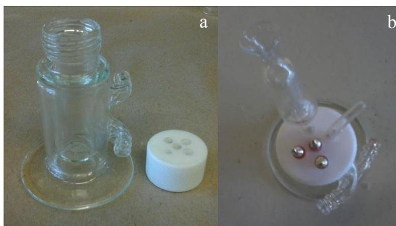
**FIGURA 21:** Vista lateral (a) e superior (b) da célula eletroquímica
