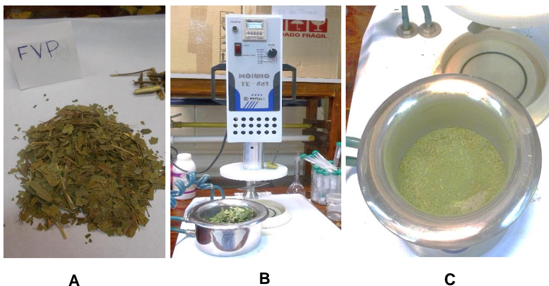
FIGURA 3.1. Etapas do processo de preparo das amostras comerciais. (A) Separação dos galhos das folhas das amostras. (B) Imagem do moinho. (C) Amostra após passar pelo moinho de facas
