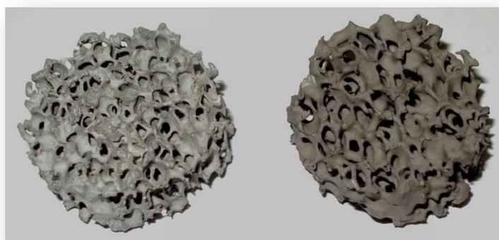
FIGURA 3.2 - Filtros cerâmicos utilizados na deposição dos filmes finos. À direita 15 ppi e a esquerda 10 ppi.
