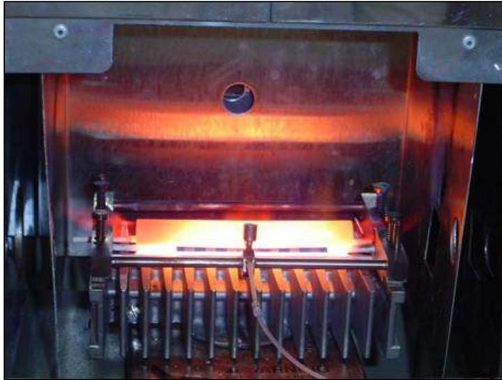
FIGURA 6.2.2. Tubo com maior orifício e penetração dos gases da chama verificados pela introdução de uma solução  $1000 \text{ mg L}^{-1}$  de Sr(II)
