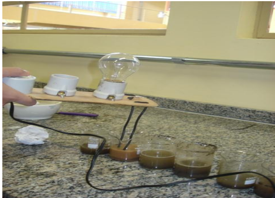
Figura 18 – Verificando a condutibilidade elétrica
