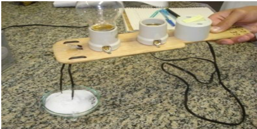
Figura 13 – Aparelho e medida da condutibilidade do cloreto de sódio no estado sólido
