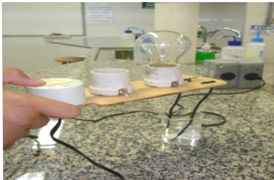
Figura 11 – Aparelho e medida da condutibilidade da água destilada
