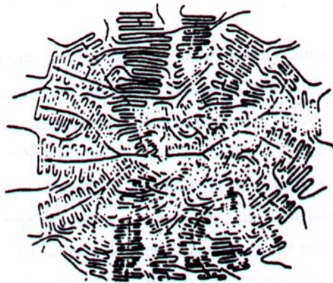
Figura 2.6: Esfereulito do polipropileno [13].
