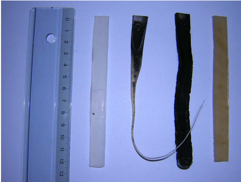
Figura 4.36: Matriz e nanocompósito antes e após o ensaios de queima vertical.
