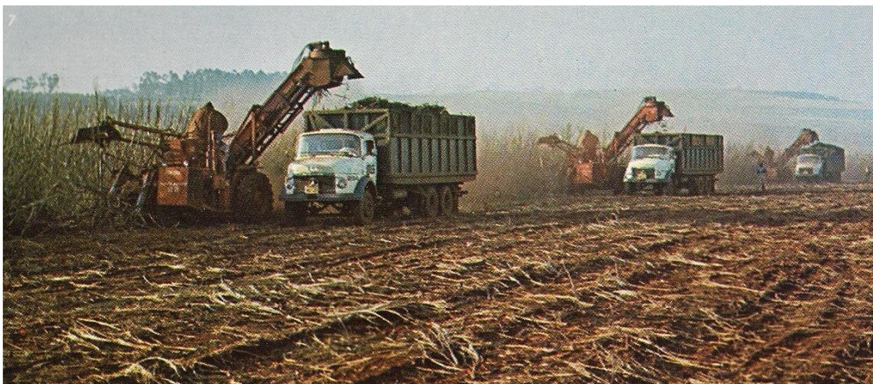
**Foto 7** – Carregamento mecanizado de cana-de-açúcar.
