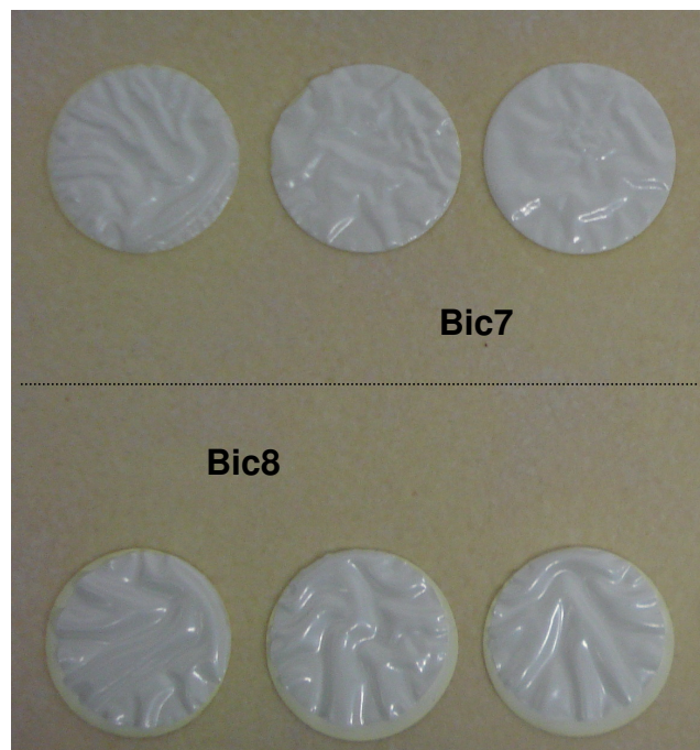
Figura 4.90 Amostras de Bic7 e Bic8 sinterizadas a 1450 °C/2h.
