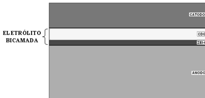
Figura 2.9 Estrutura esquemática de PaCOS com eletrólito bicamada CDG/ZEI-8.
