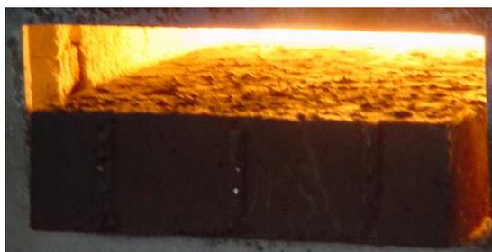
Figura 3.11 Amostra do concreto 10SBC posicionada na entrada do forno durante teste de choque térmico para avaliação do efeito do lascamento.
