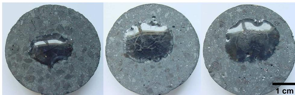
Figura 4.31 Fotos das amostras obtidas após três testes distintos (temperatura máxima atingida = 1530°C) envolvendo a escória ES0 e o concreto 10SBC.
