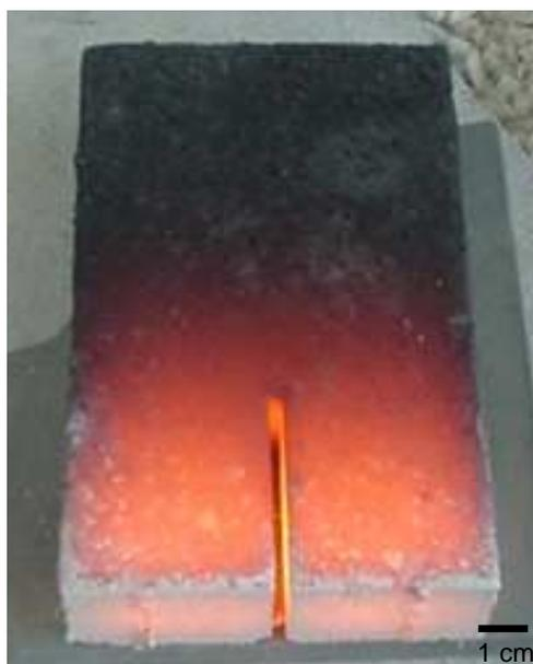
Figura 4.53 Fotografia da amostra do concreto 10SBC logo após a retirada do forno.
