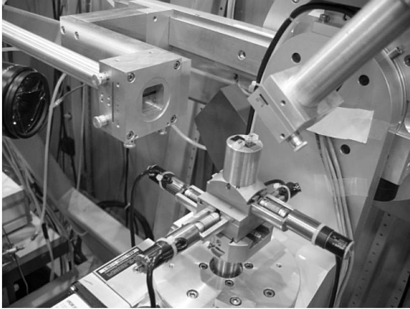
Figura 3.6 Amostra preparada para medidas na linha D11A.
