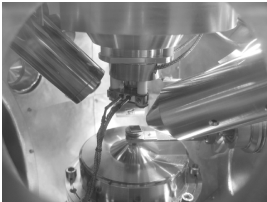
Figura 3.5. Amostra de NEG no porta-amostra do espectrômetro de XPS.
