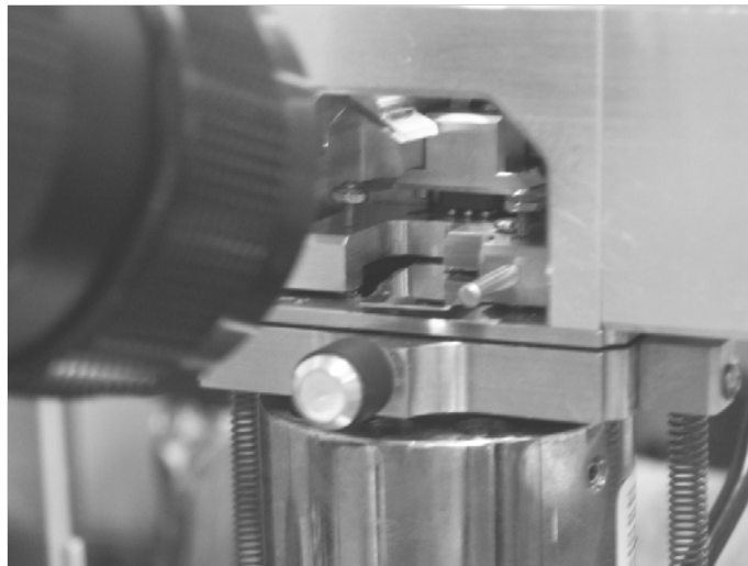
Figura 3.3 Amostra de Au sobre Si (111) montada no MFA.
