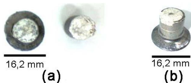
Figura 4.21-Fotos das amostras processadas por extrusão a quente em diferentes temperaturas: (a) 2MgFe-V1**T200**R3 vista de cima (partida em duas); (b) 2MgFe-V1**T300**R3 vista de lado (inteira).
