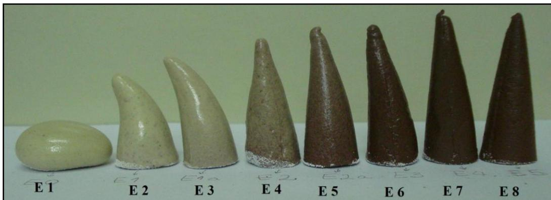
Figura 4.8 Resultado obtido para os corpos de prova das composições entre o fundente sintético e a massa de Santa Gertrudes após a queima a 1100°C. Cone com 1,5cm de diâmetro e 3,5cm de altura.
