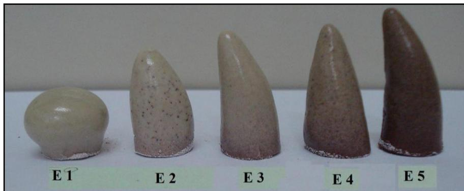
Figura 4.11 Resultados obtidos para os corpos de prova, contendo fundente sintético, após a queima em 1100°C com elevada taxa de aquecimento. Cone com 1,5cm de diâmetro e 3,5cm de altura.
