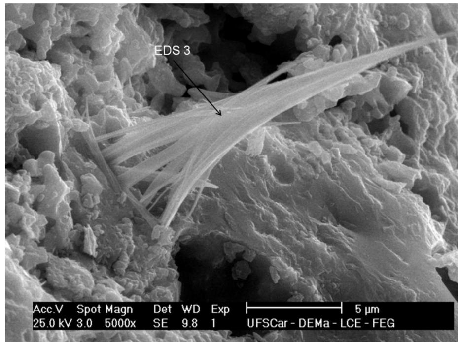
Figura 4.19 Micrografia obtida por MEV: Detalhamento da microestrutura da composição E8 (0/100), para temperatura de 1100°C com patamar de 5 minutos.
