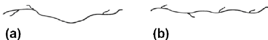
Figura 2.2 Representação esquemática do (a) HDPE e (b) LLDPE [1].
