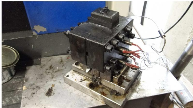
Figura 19 – Matriz de ECAP com sistema de aquecimento.
