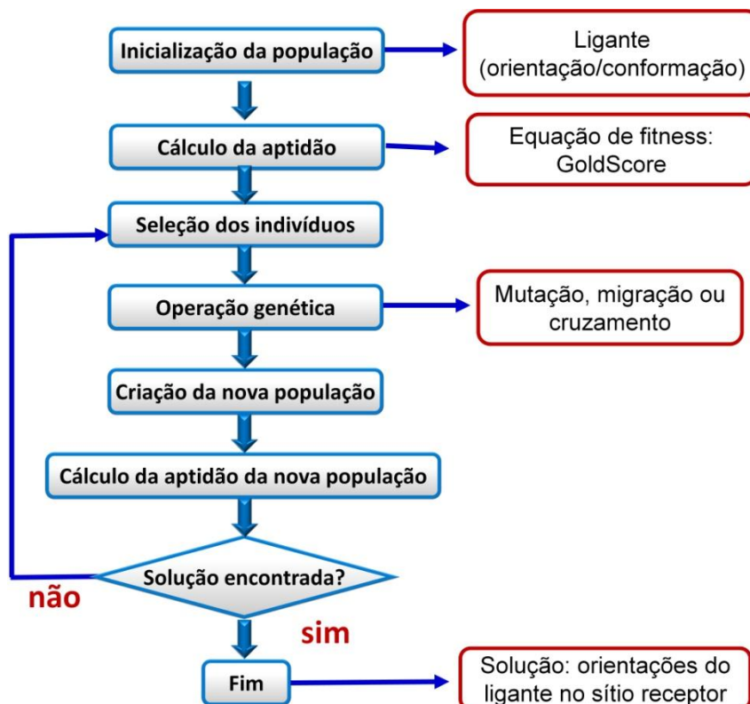
Figura 2.2 Fluxograma da operação de um algoritmo genético (adaptação de Miranda, 2000; Corrêa, 2010).
