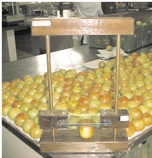
Figura 16. Aplanador utilizado para medição da firmeza de tomates. Fonte: Moretti (2006).
