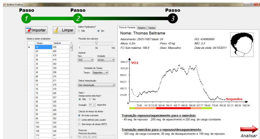
Figura 18: Ambiente de análise da cinética. Este formulário deve ser preenchido seguindo os 3 passos mostrados na porção superior da tela. O Passo 1 se refere a importação dos dados em extensão *.csv, o passo 2 se refere as opções de análise dos dados e o passo 3 se refere ao processamento dos dados.
