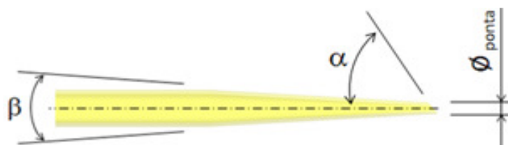
Figura 14: Características geométricas da ponta do sensor termoelástico.
