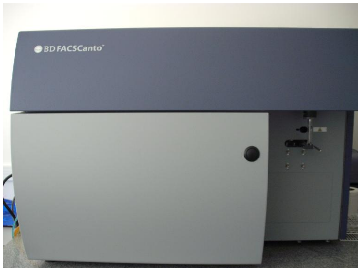
FIGURA 15. Aparelho FACSCanto, FCFRP-USP: Utilizado para fazer análise de citometria de fluxo. Fonte: Laís C. de Souza, 2010.
