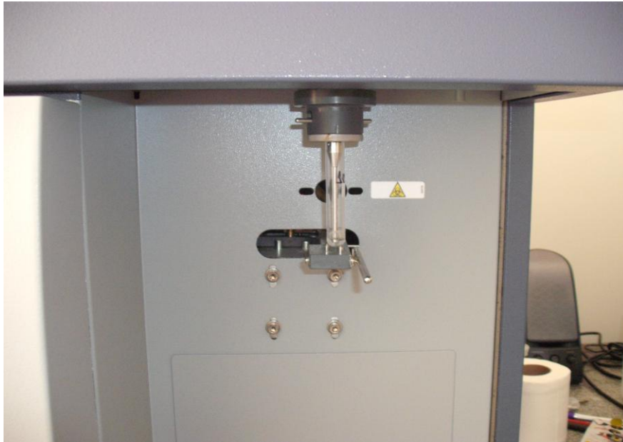
FIGURA 16. Aparelho FACSCanto, FCFRP-USP: Utilizado para fazer análise de citometria de fluxo.
