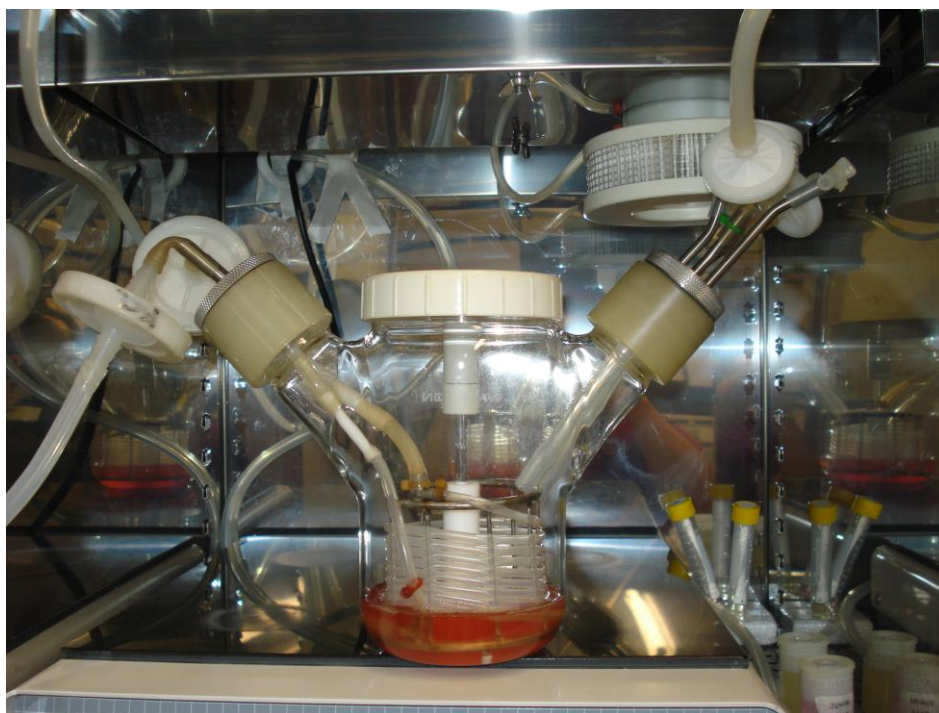
FIGURA 6. Biorreator de 500mL frasco tipo spinner : Frasco com o volume de trabalho de 200mL utilizado para o cultivo dos hibridomas, LATECC-UFSCar.
