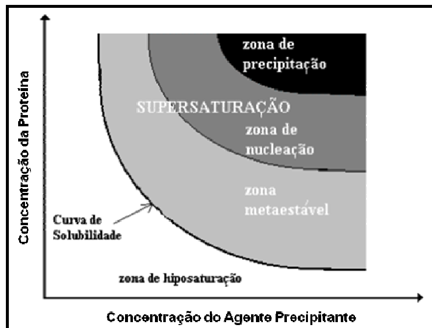
Figura 11 - Representação esquemática do Diagrama de Fases para cristalização de proteínas (modificada de McPherson, 2003).
