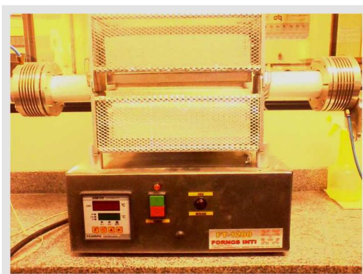
Figura 3.2 Forno tubular utilizado nos diferentes tratamentos térmicos as amostras.
