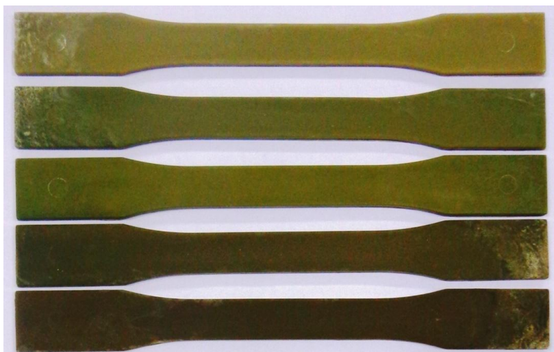
Figura 5.36 Imagem dos corpos de prova dos nanocompósitos. De cima para baixo: TPS/PCL 75/25, TPS/PCL III, 1,8TPS/PCL, 3,6TPS/PCL e 7,2TPS/PCL.
