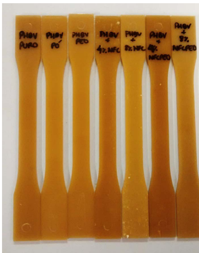
Figura 5.57 Corpos de prova de tração dos nanocompósitos obtidos por extrusão/injeção. Da esquerda para a direita: PHBV puro, PHBV pó, PHBV-PEO, PHBV-4NFC, PHBV-4NFCPEO, PHBV-8NFC, PHBV-8NFCPEO.
