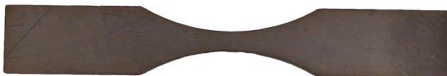
(b) Corpo de prova usinado
