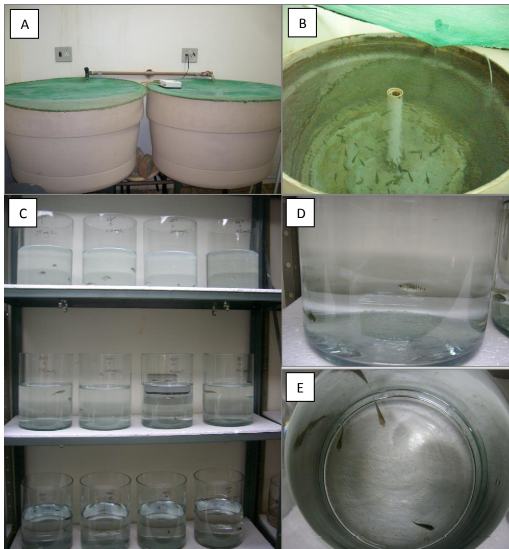
Figura 2. Procedimento experimental do ensaio de toxicidade aguda da azitromicina para a tilápia ( Oreochromis niloticus ). A e B) Caixa de aclimatação dos animais em condição de bioensaio. C) Vista geral do experimento de toxicidade aguda na sala de bioensaio. D) e E) Detalhe do experimento de toxicidade aguda.
