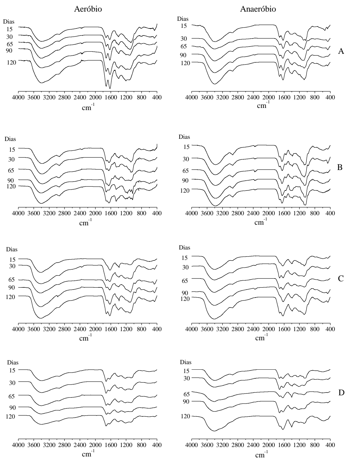
Figura 13. Espectros de infravermelho de ácidos fúlvicos dissolvidos formados na decomposição de macrófitas aquáticas, sob condições aeróbias e anaeróbias (A = Eichhornia azurea ; B = Egeria najas ; C = Oxycaryum cubense ; D = Salvinia molesta ).
