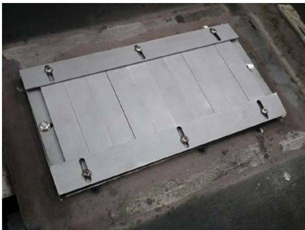
Figura 4.27 Foto das placas recobertas pelo processo de aspersão térmica HVOF e indicação das superfícies do substrato em que foram aspergidos cada pó.
