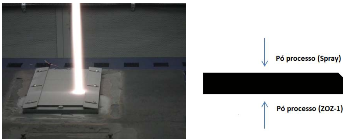
Figura 3.4 Foto do processo de aspersão térmica HVOF e indicação das superfícies do substrato em que foram aspergidos cada pó.
