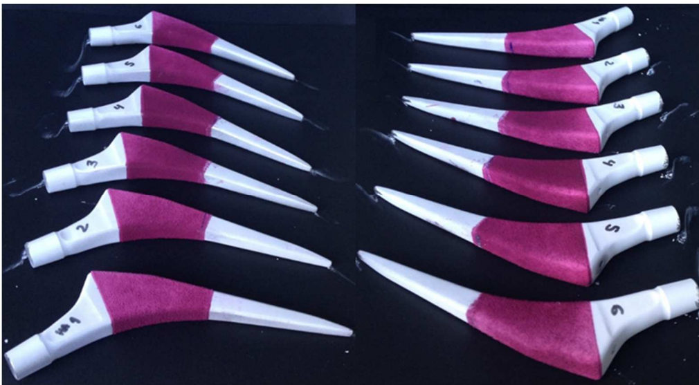
Figura 65 - Próteses TPS+HA após ensaio de líquido penetrante.
