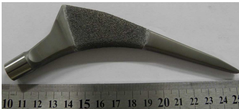
Figura 31 - Haste femoral após ataque químico 5B [56].
