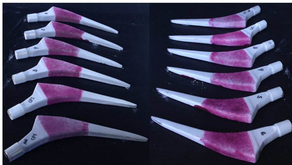
Figura 63 – Próteses TPS+AQ após ensaio de líquido penetrante.
