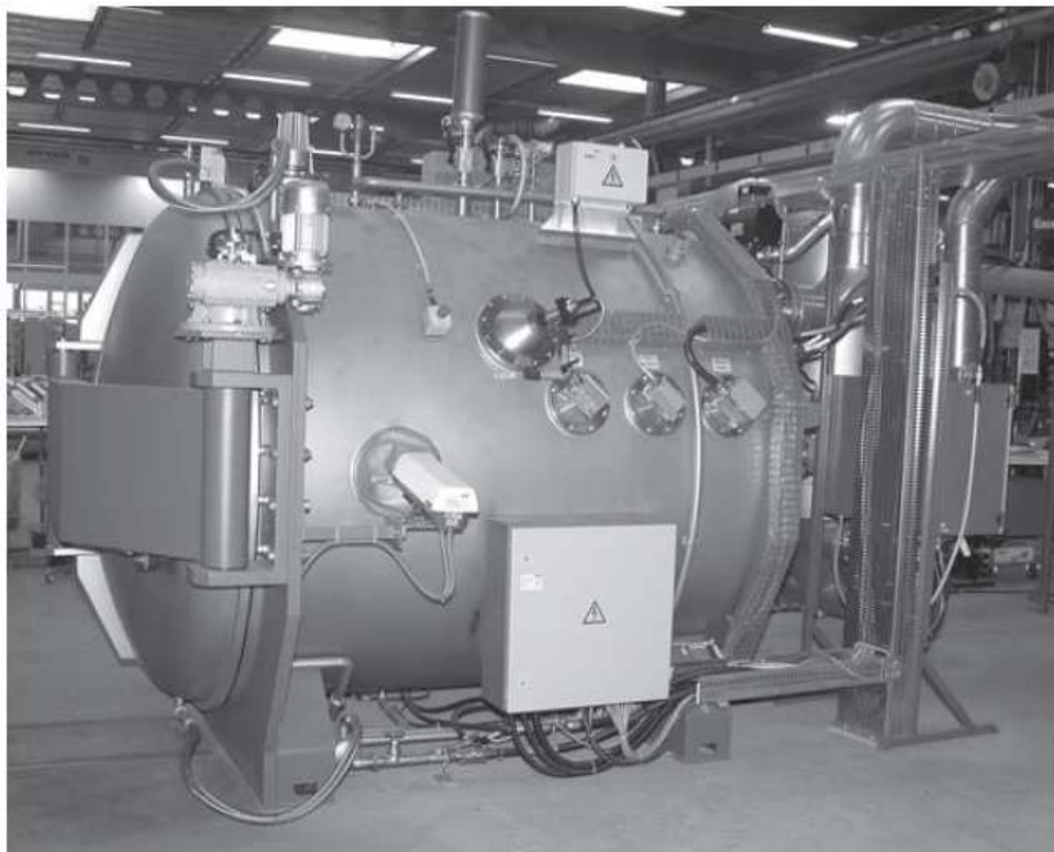
Figura 10 - Equipamento para aplicação de plasma spray a vácuo [34].
