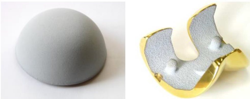
Figura 14 - Copa acetabular bipolar (esquerda) e componente femoral de prótese de joelho (direita) recobertos pelo processo BONIT® [47].
