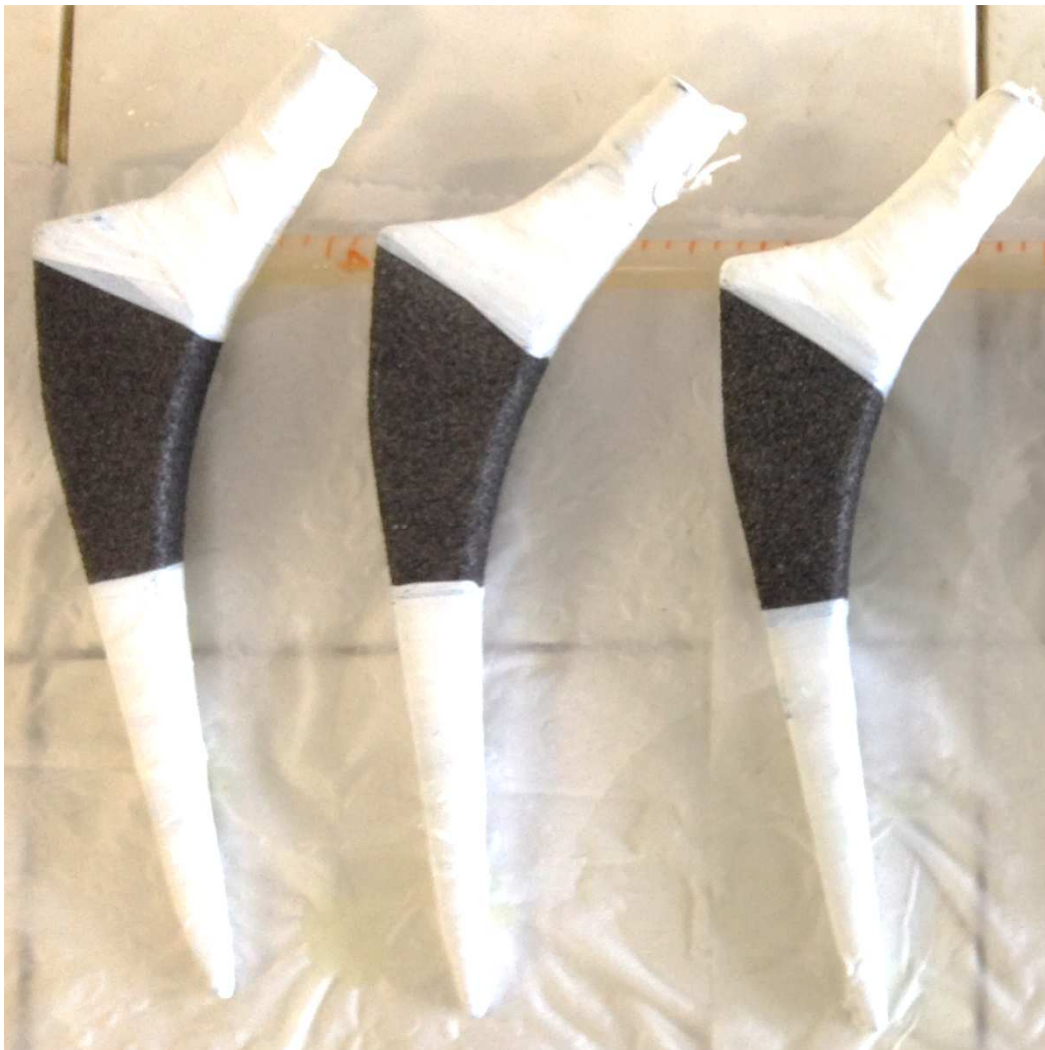
Figura 30 - Próteses após ataque químico 5B de Oliveira, D. P. [56].
