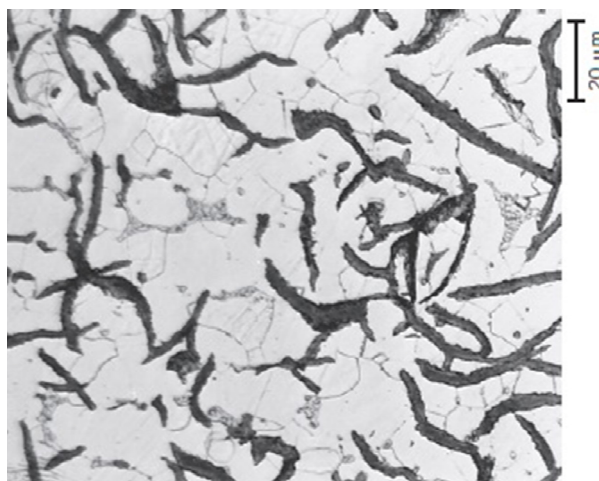
Figura 22 Fotomicrografia ótica do ferro fundido cinzento: os flocos escuros de grafita estão envolvidos por uma matriz ferrítica \alpha . Ampliação de 500x [6].
