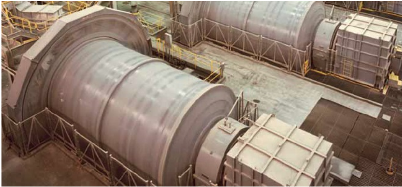
Figura 27 Equipamento de moagem de materiais por esferas metálicas em moinho rotativo [97].
