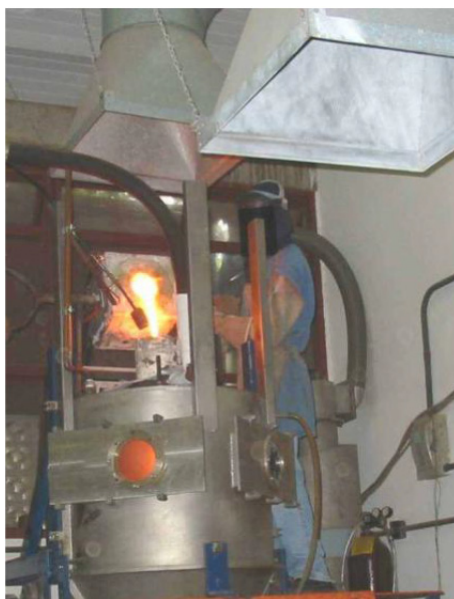
Figura 34 Equipamento de conformação por spray para atomização de pós [53].
