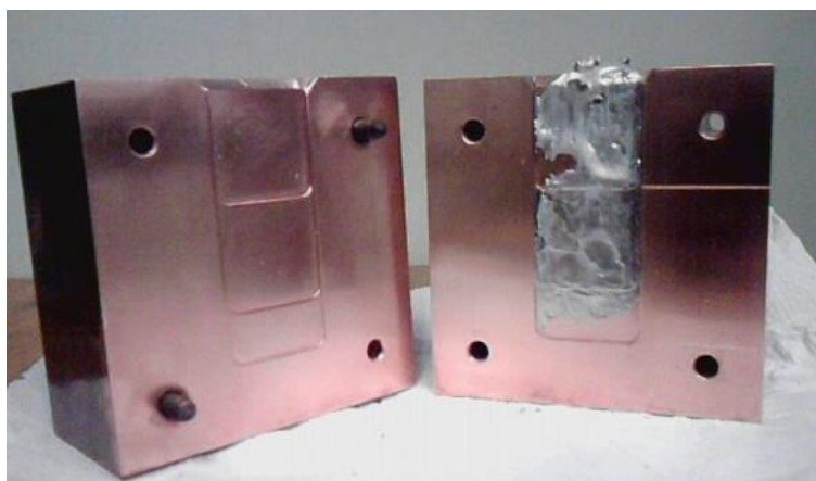
Figura 32 O molde de coquilha para produção de chapas escalonadas com espessuras de 1,0 e 2,0 mm.
