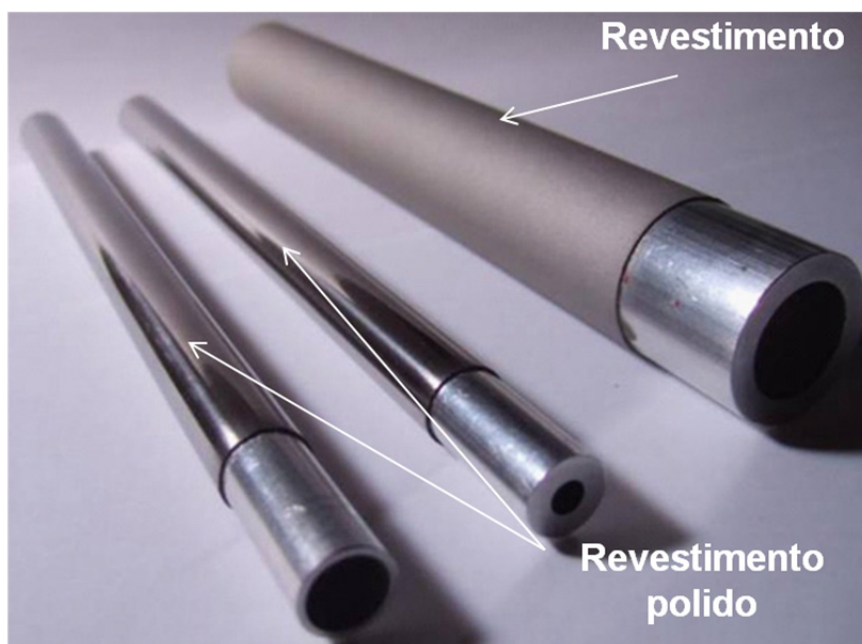
Figura 17 Tubos à base de Al revestidos com vidros metálicos a base de ferro e polidos posteriormente [65].
