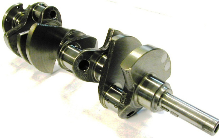
Figura 29 Virabrequim em ferro fundido dúctil.
