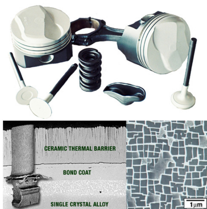
Figura 3.1 Ilustração de aplicação de TBC's em componentes de motores de combustão e turbinas [14,15].
