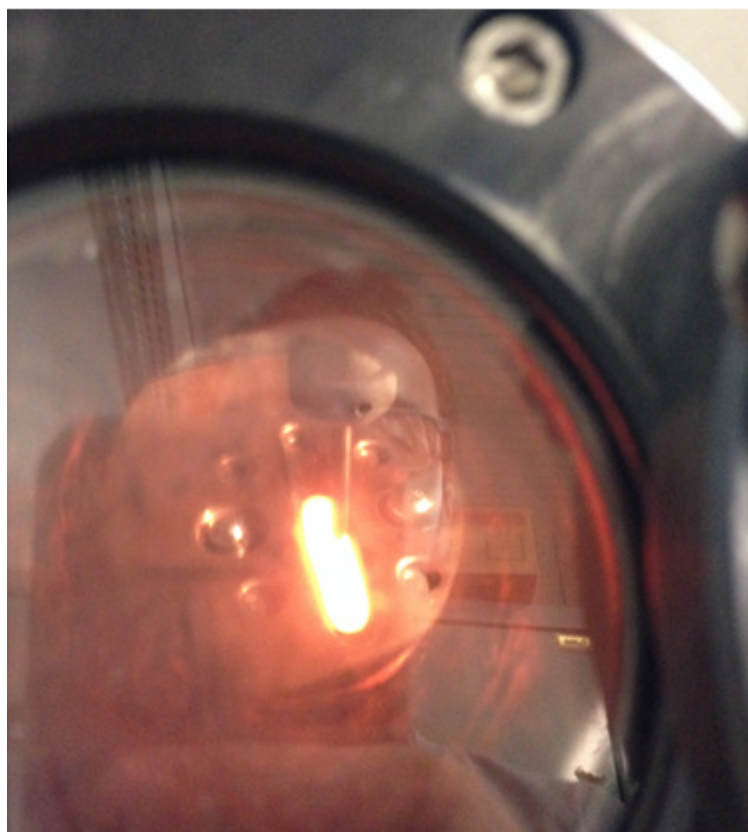
Figura 4.4 Amostra durante a solidificação em sua fabricação em forno a arco.
