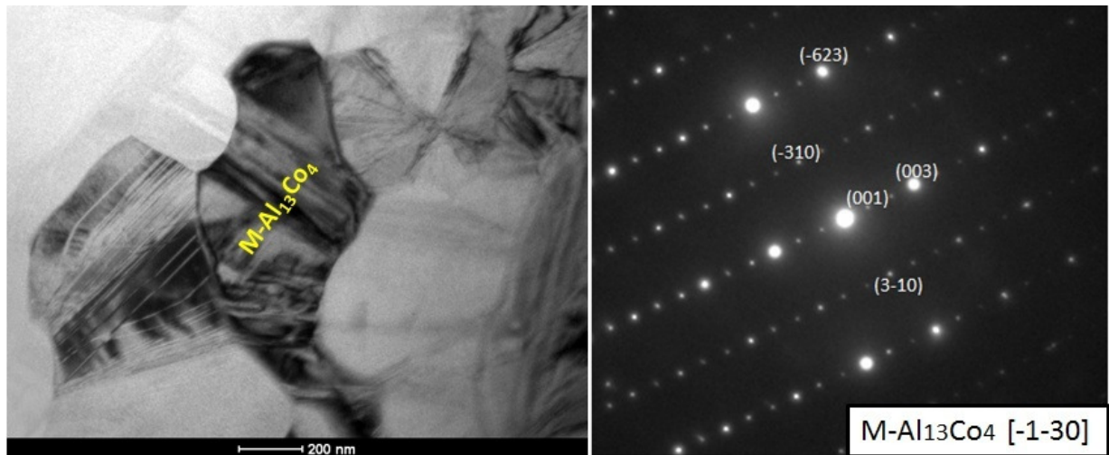
Figura 5.60 Imagem de MET da amostra QC5_MS em campo claro com o padrão de difração de elétrons da fase monoclinica \text{Al}_{13}\text{Co}_4 no eixo de zona [-1-30] .
