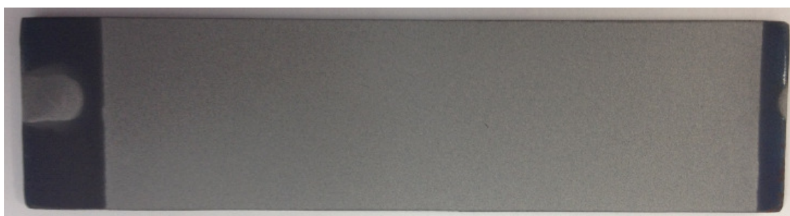
Figura 4.2 Revestimento fabricado com a liga QC1 por HVOF.
