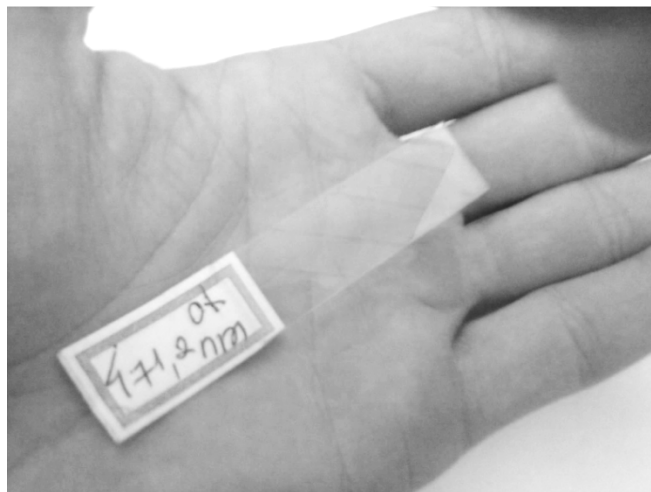
Figura 3.6 Amostra de polycarbonato usada na validação do polarímetro.
