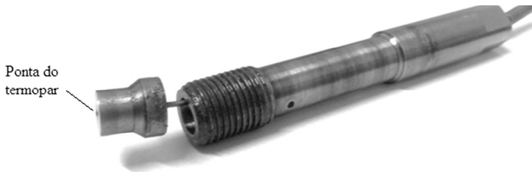
Figura 3.12 Termopar adaptado a uma ponteira convencional de transdutor de pressão para avaliação da temperatura na região interna da matriz.
