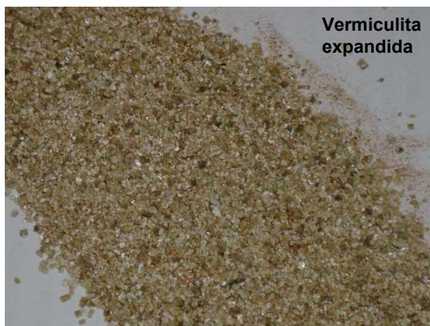
Figura 3.1 Vermiculita expandida utilizada nas argamassas.
