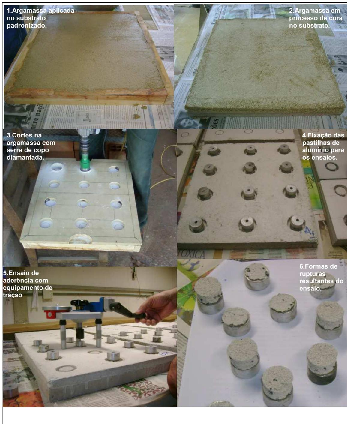
Figura 3.10 Etapas do ensaio de aderência à tração
