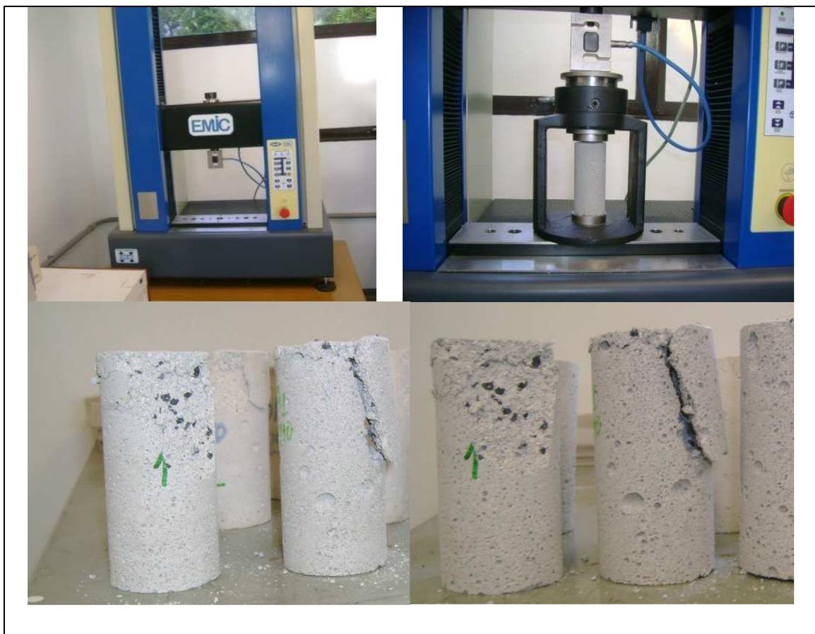
Figura 3.7 Ensaio de resistência à compressão uniaxial
