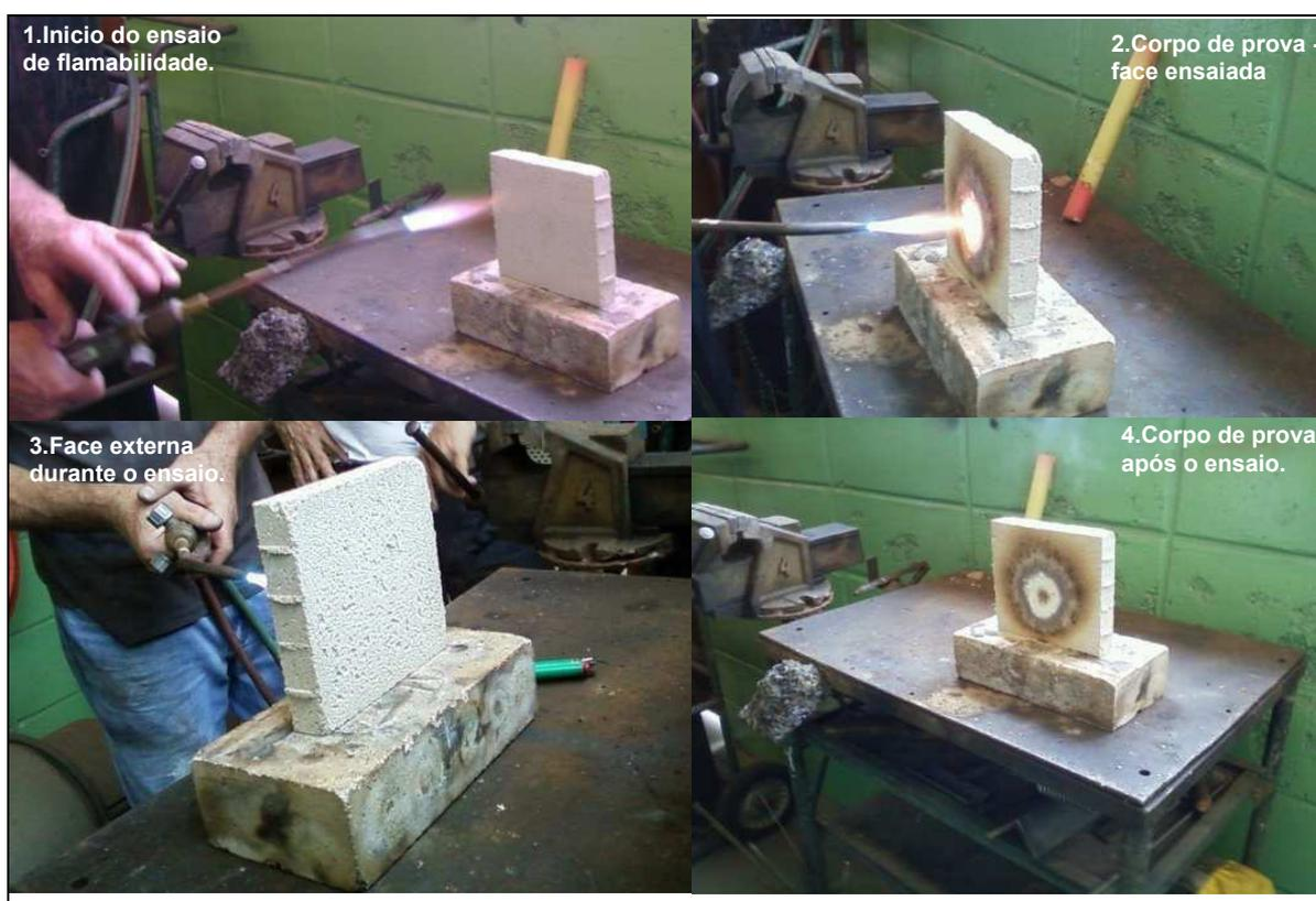
Figura 4.30 Ensaio de flamabilidade com maçarico
