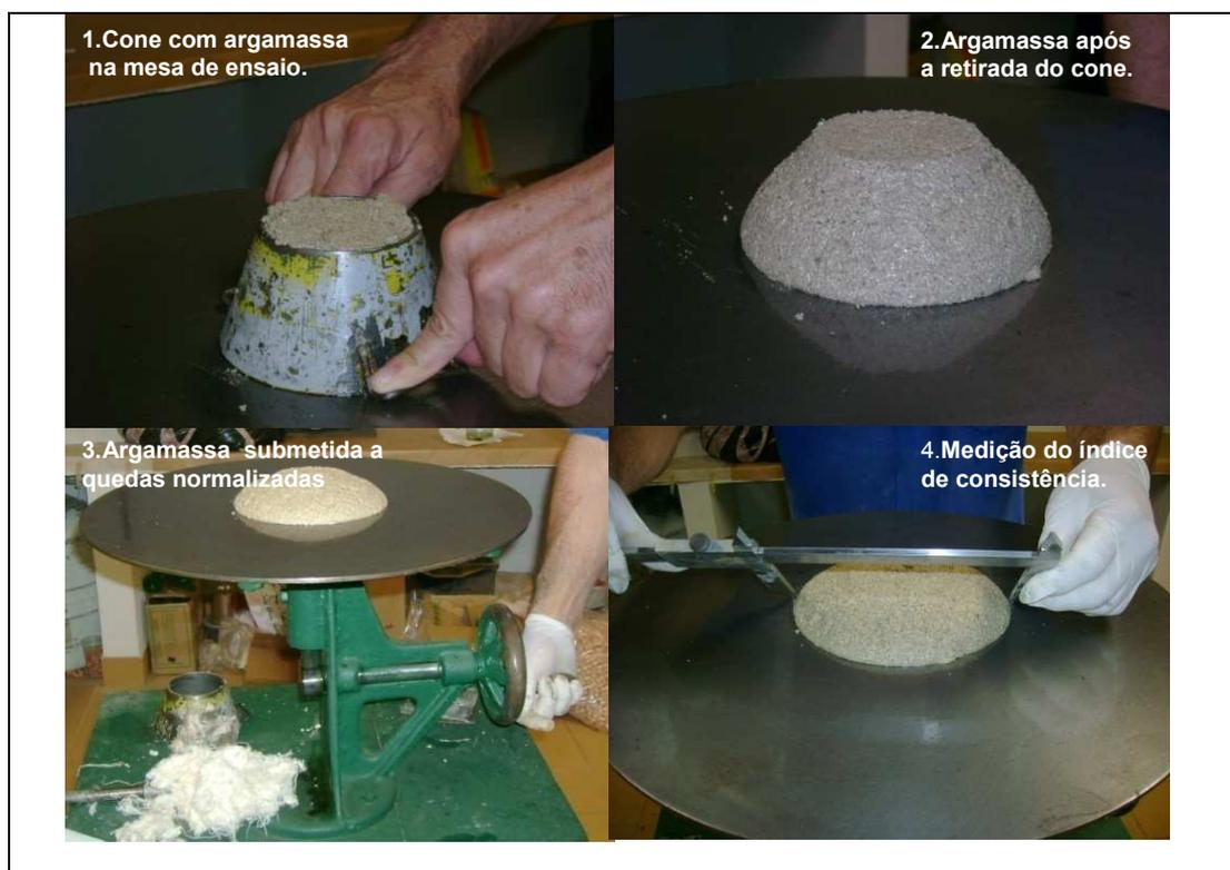
Figura 3.5 Ensaio de consistência
