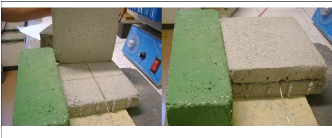
Figura 3.13 Ensaio do fio quente (cruz de medição)
