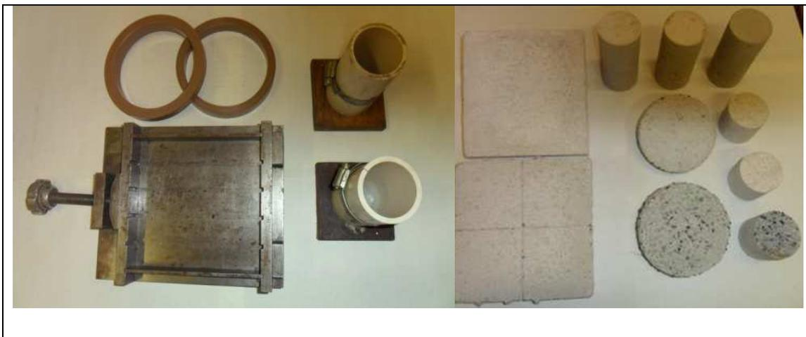
Figura 3.4 Formas e Corpos de Prova
