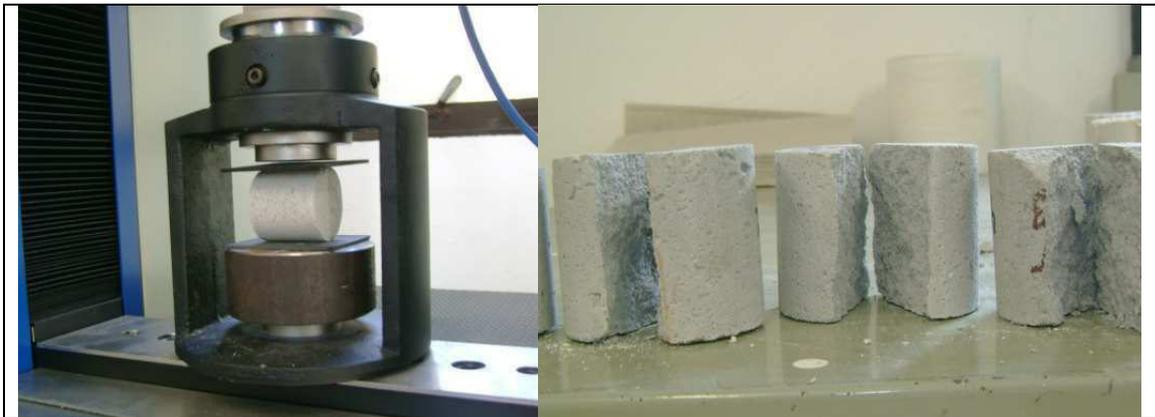
Figura 3.9 Ensaio de resistência à compressão diametral
