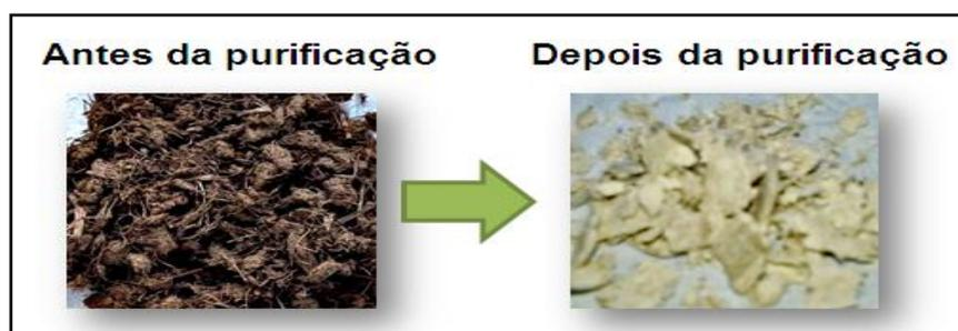
FIGURA 2.15 - Bagaço de cana-de-açúcar antes e depois do processo de purificação.
