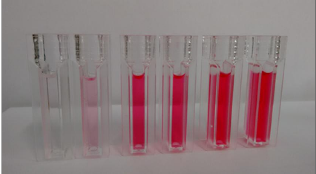
Figura 5. Soluções para a construção da curva padrão com diferentes concentrações de AIA comercial (Sigma) (ARAÚJO et al., 2014).
