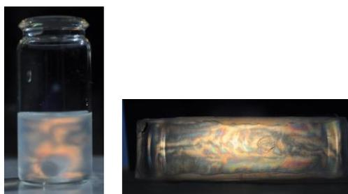
Figura 5.2 Fotografias da suspensão aquosa de NCC\_CMC (a) e do filme de NCC (b) observados entre lentes polarizadoras.
