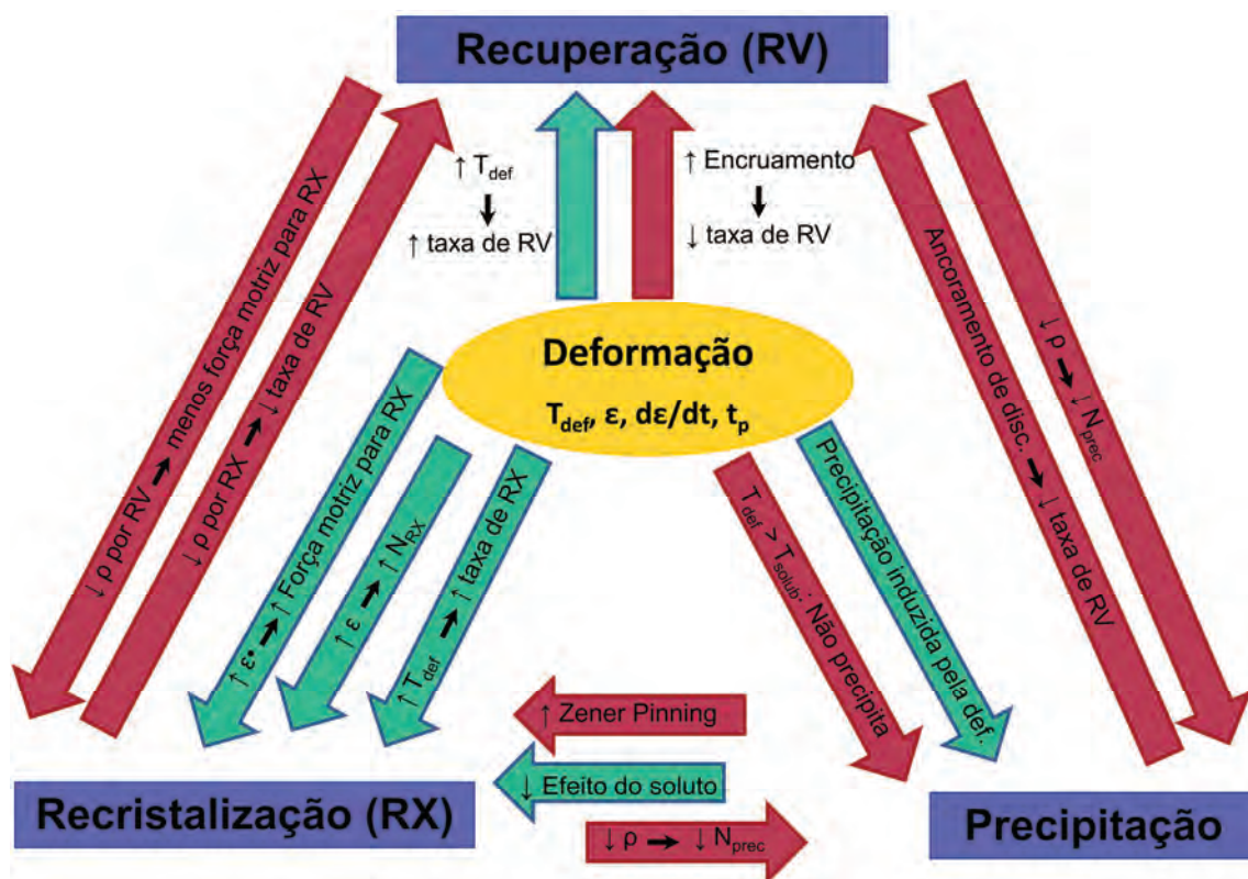
Figura 2.2 Esquema ilustrativo das interações entre deformação, recuperação, recristalização e precipitação, adaptado [50]. Setas vermelhas representam efeitos retardadores dos processos e setas verdes efeitos que os aceleram. Onde \rho = densidade de discordâncias, N_{RX} = números de sítios de nucleação para a recristalização e N_{prec} = números de sítios de nucleação para a precipitação.
