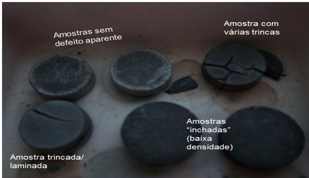
Figura 4.54 Amostras sinterizadas a 1700°C produzidas com os pós obtidos a partir das reações C e N e lixiviados com solução 20% de ácido clorídrico.
