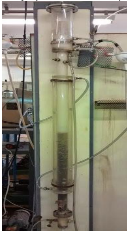
Figura 3.4: Reator EGSB em operação durante a co-fermentação de SQP e glicerol bruto.
