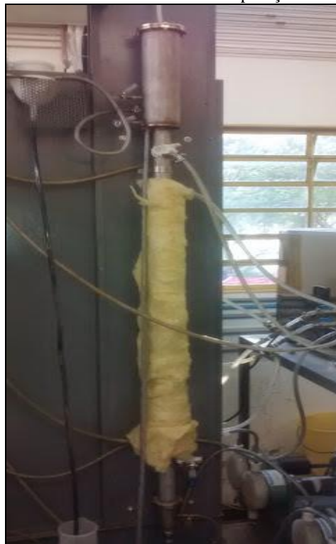
Figura 3.2: RALF termofílico em operação contínua.
