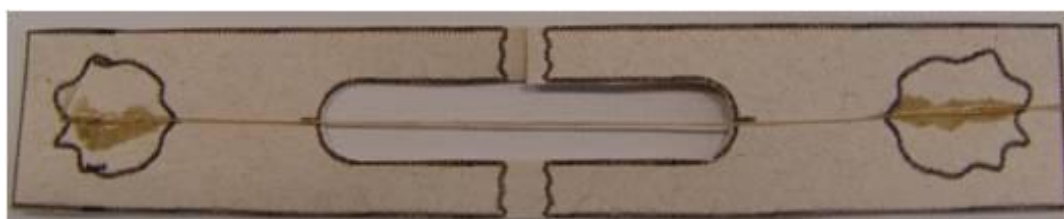
Figura 4.7 Corpos de prova para ensaio de tração dos feixes de PALF.
