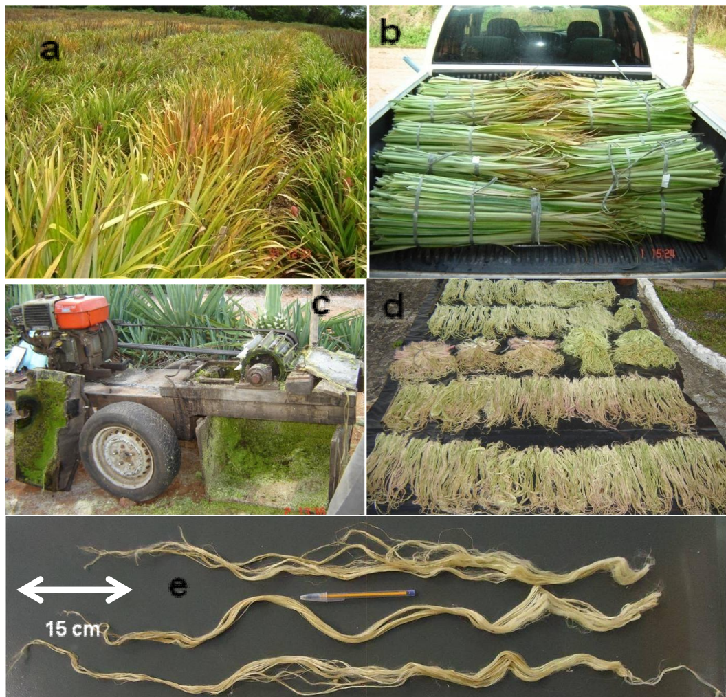
Figura 4.1. (a) Plantação de abacaxizeiros Potyra. (b) folhas cortadas de Potyra. (c) máquina desfibadora de sisal utilizada. (d) feixes de fibras secando ao ambiente. (e) feixes de PALF de Potyra secos.
