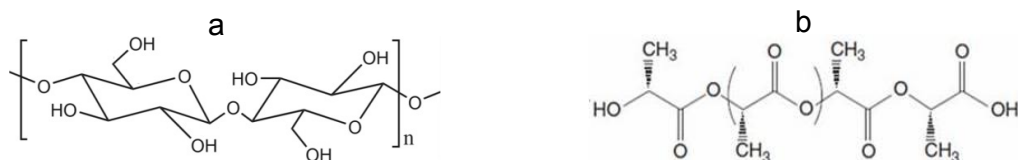
Figura 3.1. (a) unidade estrutural da celulose. (b) estrutura do PLA.
