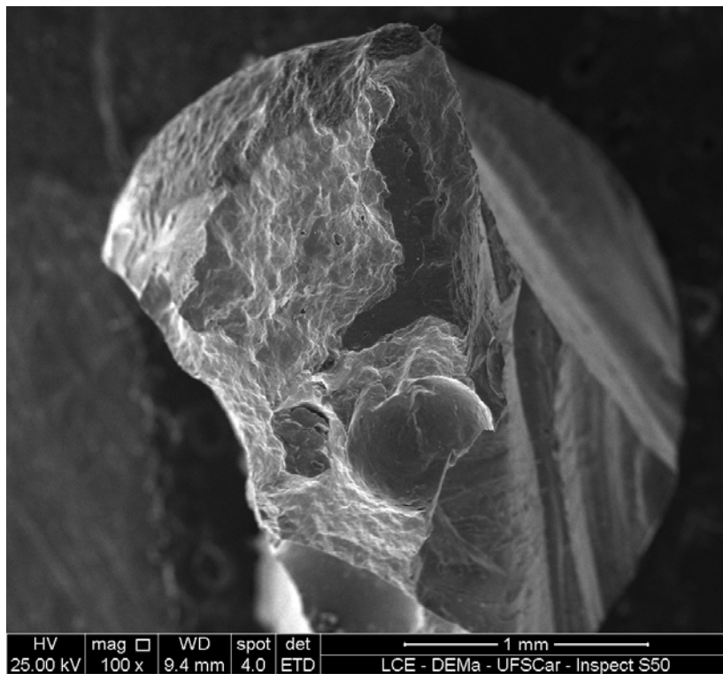
Figura 5.27. Vista geral da amostra fraturada Mg_{70}Zn_{28}Ca_2 .
