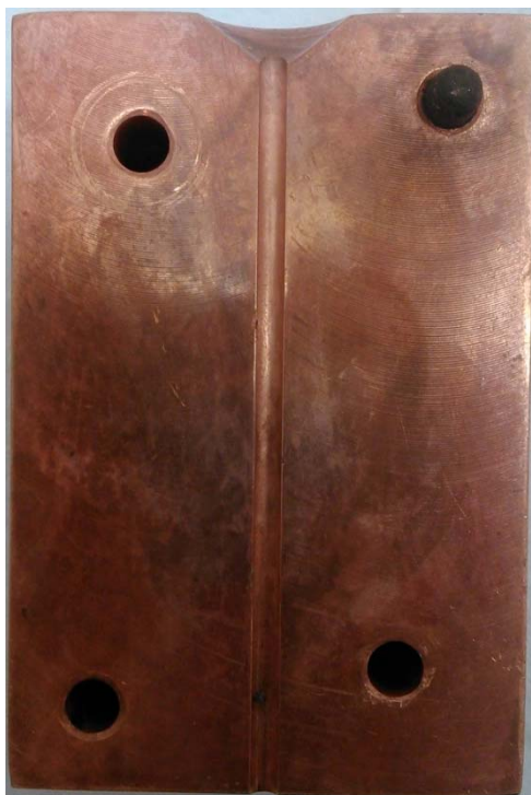
Figura 4.5. Coquilha de cobre para amostras de ensaio mecânico e corrosivo.
