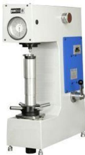
Figura 3.14. Durômetro Pantec-Panambra RASN RS + 62,5 Kgf.
