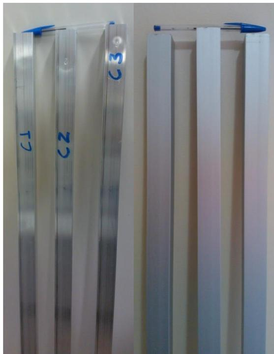
Figura 4.32 Imagens pré e pós anodização fosca do perfil 340076 produzido com tarugos representativos das condições C1, C2 e C3.
