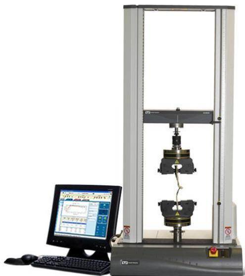
Figura 3.17. Máquina Universal de Ensaio de Tração – Instron 3369
