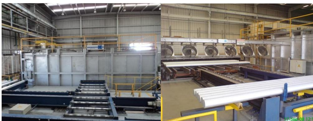
Figura 3.7. À esquerda foto da mesa de transferência e do forno de homogeneização da Sapa Aluminium Brasil S.A., à direita foto da mesa de resfriamento do forno de homogeneização.
