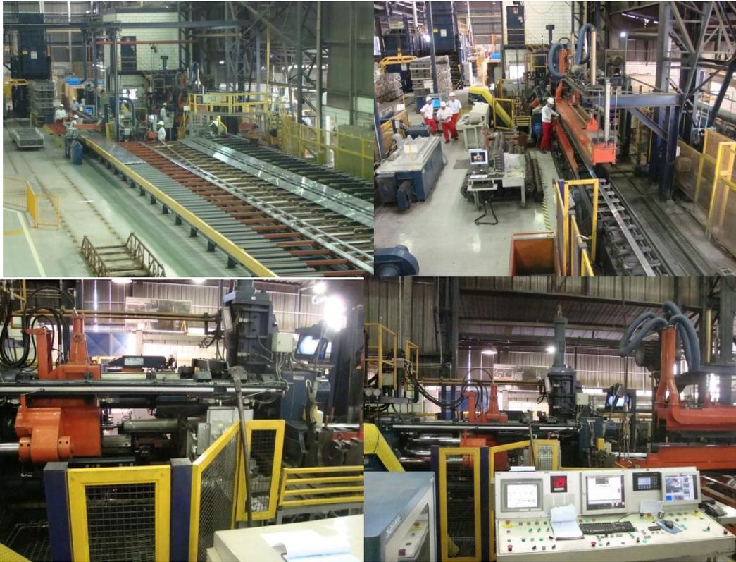
Figura 3.9. P13 – Prensa de extrusão (P13) da Sapa Aluminium Brasil S.A. onde os tarugos nas condições C1, C2 e C3 foram testados.
