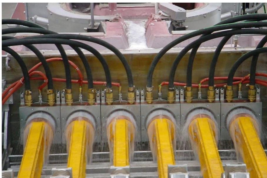
Figura 3.1. Sistema de Vazamento HDC no momento de startup de produção de tarugos de 6".
