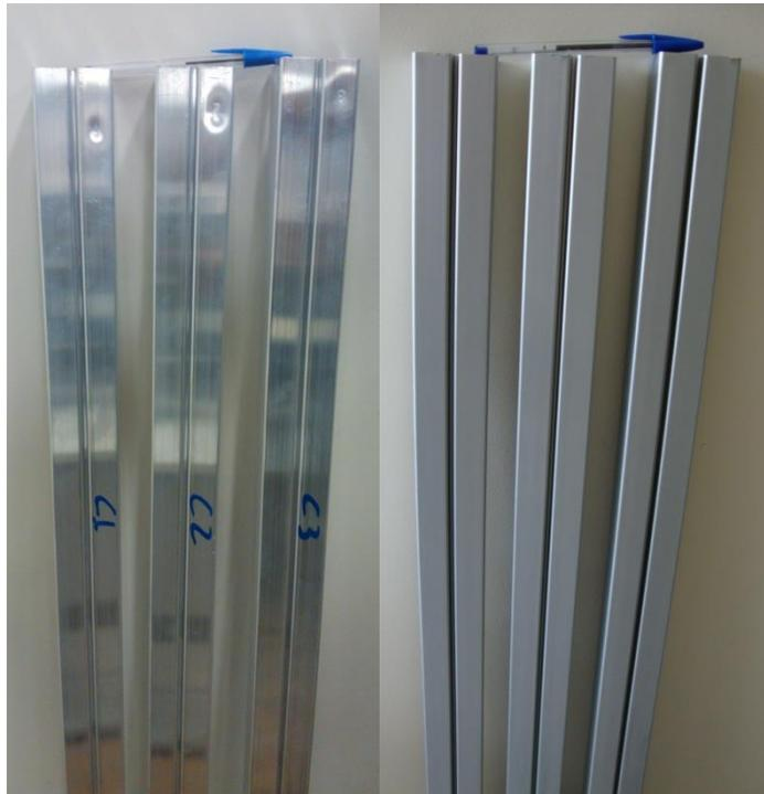
Figura 4.31 Imagens pré e pós anodização fosca do perfil 550897 produzido com tarugos representativos das condições C1, C2 e C3.
