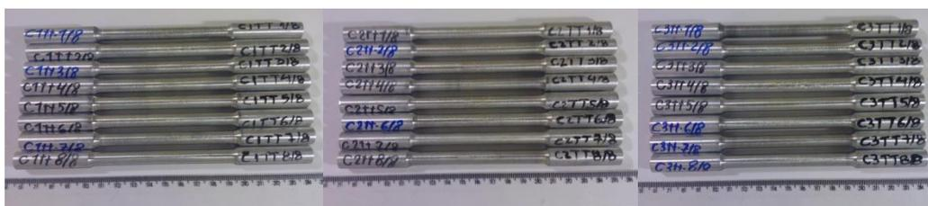
Figura 3.16. Amostras das condições C1, C2 e C3 preparadas para ensaio de tração.
