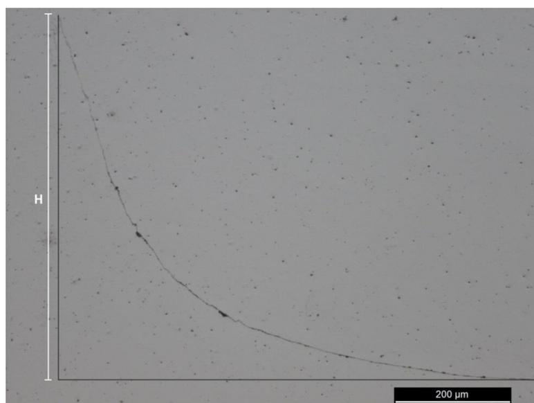
Figura 3.3 - Método desenvolvido para medir o "comprimento da cunha".
