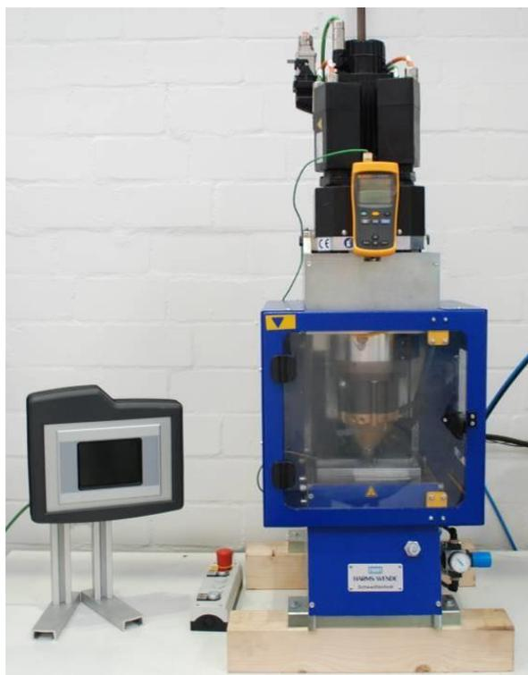
Figura 3.2 - Equipamento Harm's & Wende RPS 100 utilizado na produção das juntas.
