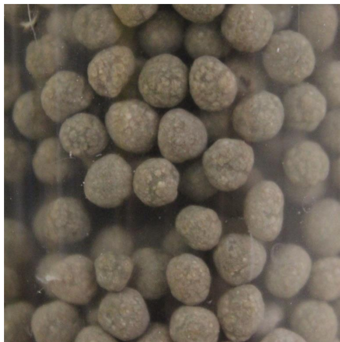
Figura 5. 17 – Grânulos no interior do reator EGSB na fase 3.
