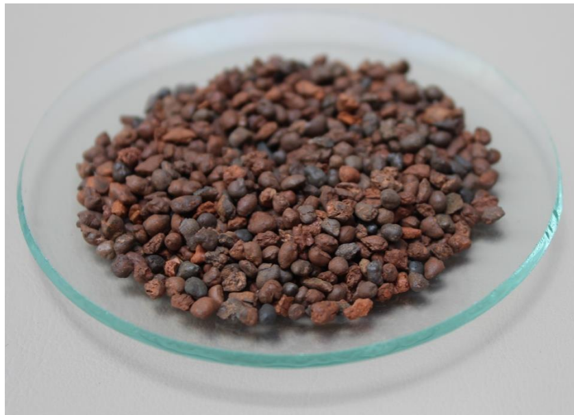
Figura 4. 2 – Cinasita, material suporte do RALF.
