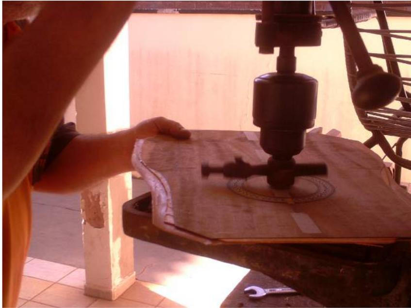
Figura 60 – Abertura do orifício da boca em tampo com roseta
