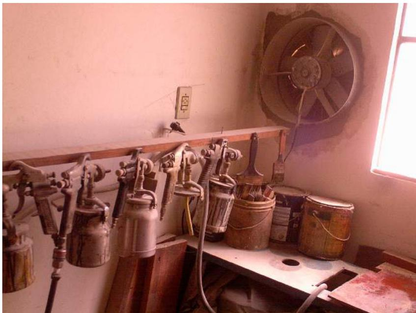
Figura 49 – Quarto do verniz e revolver de seladora e verniz
