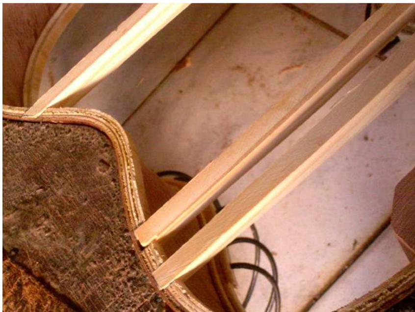
Figura 53 – Caixa acústica com hastes sendo fixadas nas laterais
