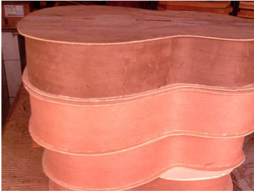
Figura 39 – Caixa fechadas prestes a serem prensadas
