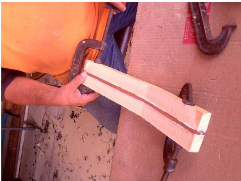
Figura 33 – Duas metades e um tensor em processo de colagem (braço base)
