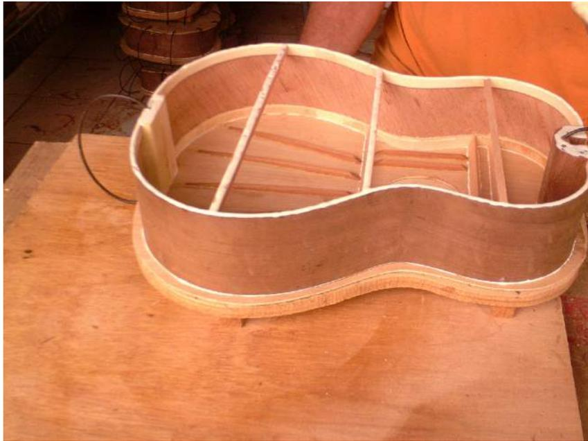
Figura 14 – Fôrma aberta com travessas atadas e frente em pressão para colagem
