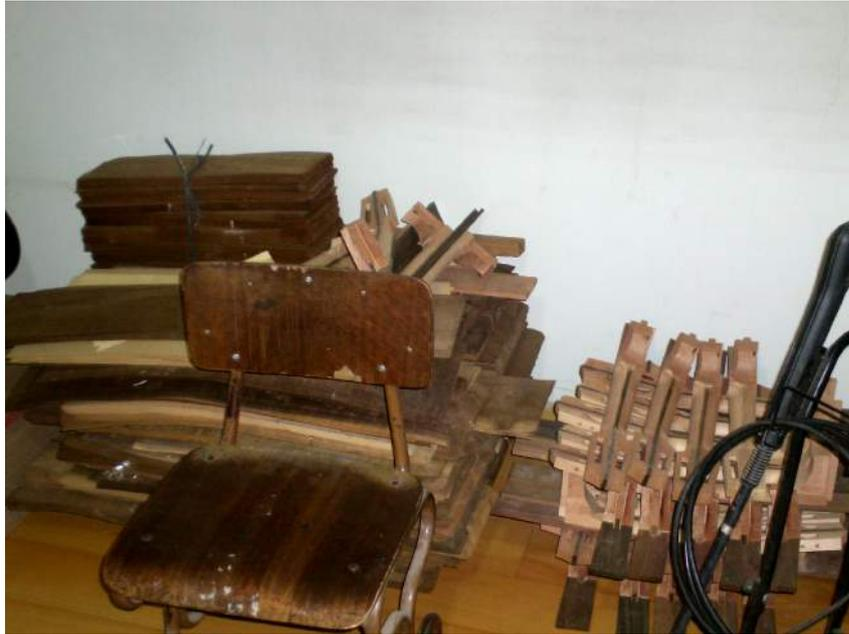
Figura 35 – Estoque de braços-escala e madeiras duras para escala, laterais e fundos
