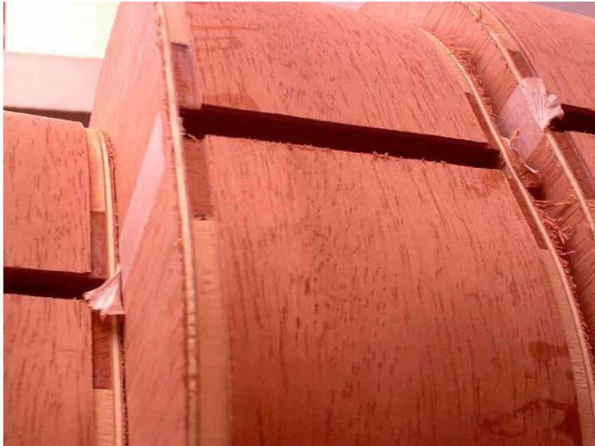
Figura 54 – Caixa acústica com ranhura para encaixe do braço parcialmente aberta
