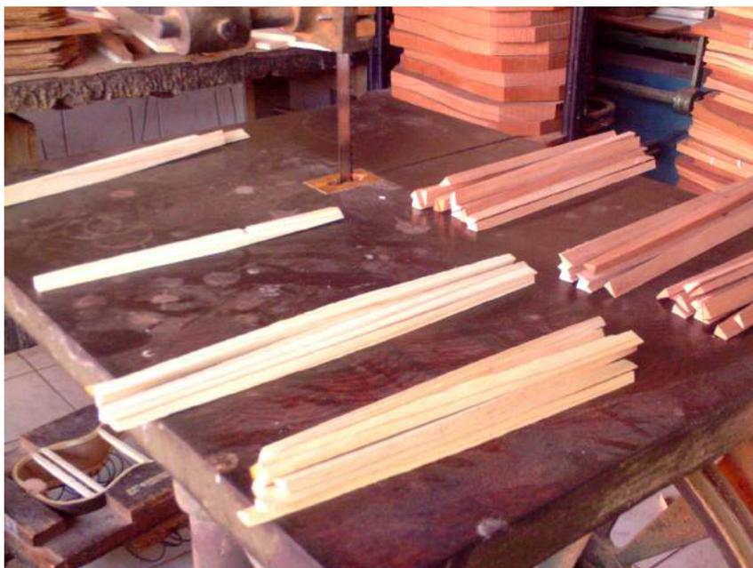
Figura 47 – Hastes de estrutura interna preparadas
