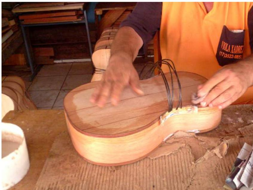
Figura 58 – Filete pressurizado para colagem
