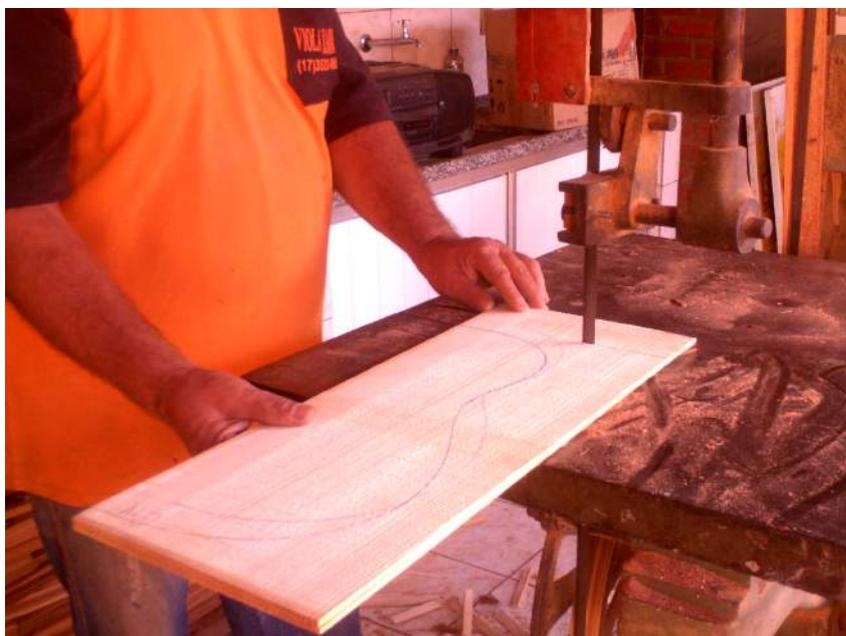
Figura 44 – Metades do tampo sendo controladamente cortadas
