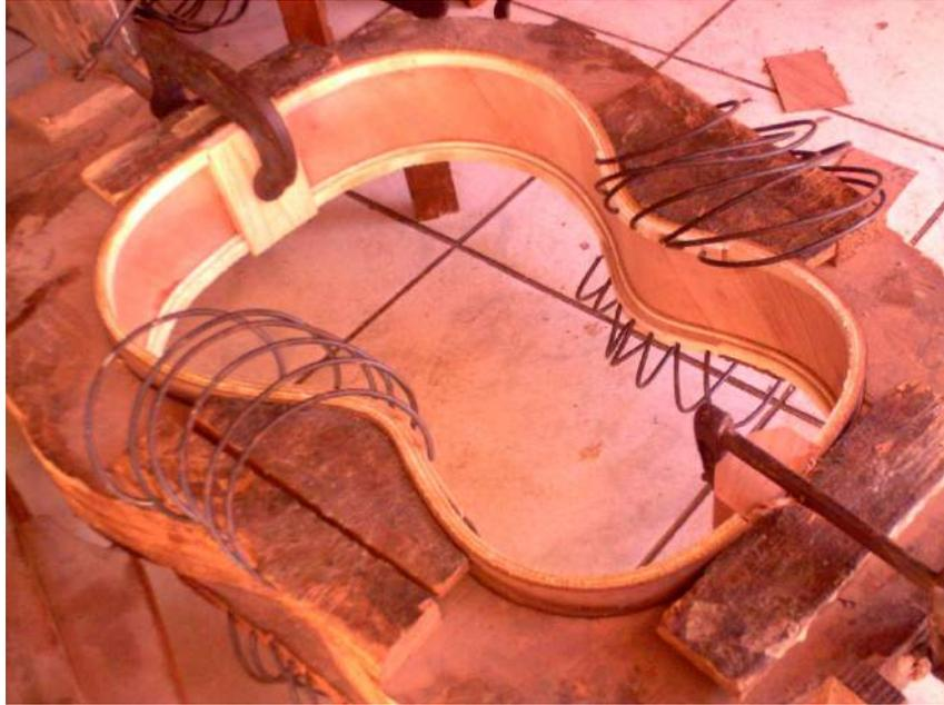
Figura 12 – União de laterais em uma fôrma
