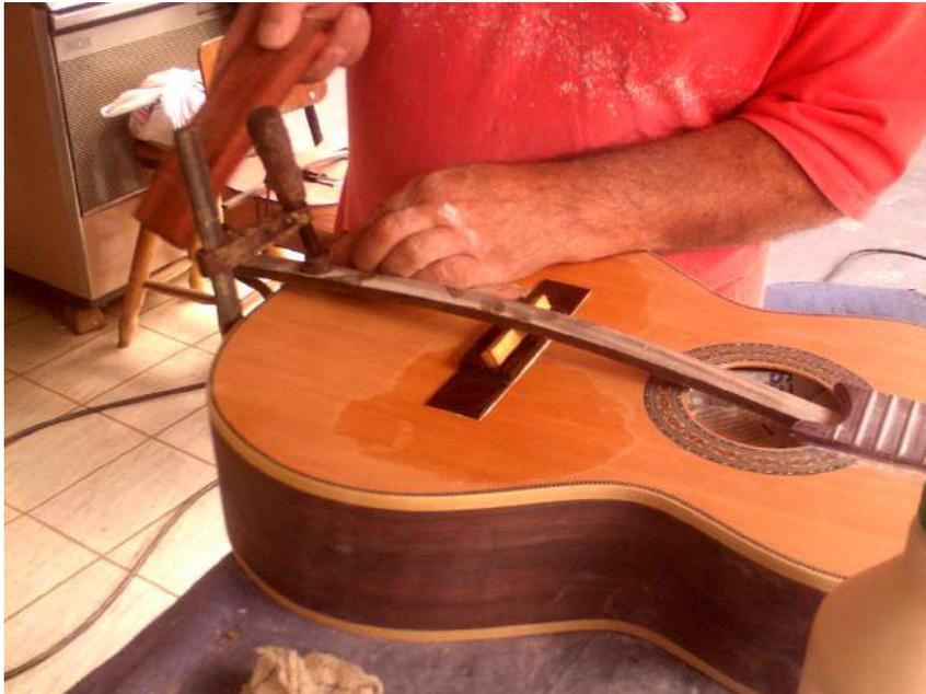
Figura 66 – Arco de pressão para colagem de cavalete
